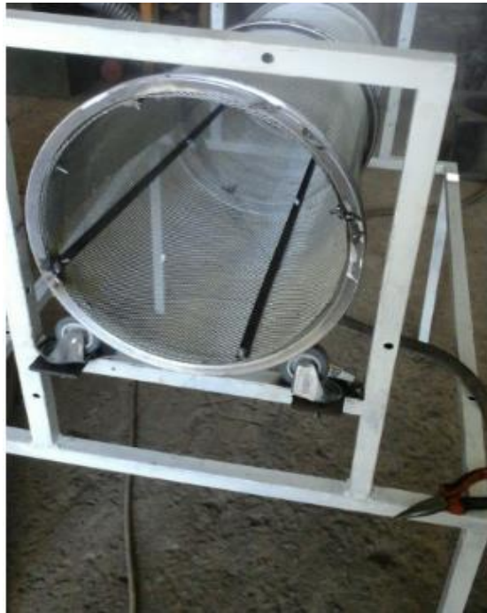
Figura 21: Rodinhas fixas a estrutura.
