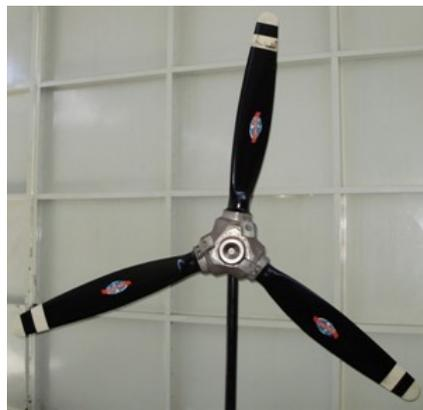
Figura 5 – Hélices ajustáveis no solo
