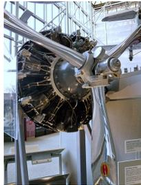
Figura 6 – Hélice de passo controlável
