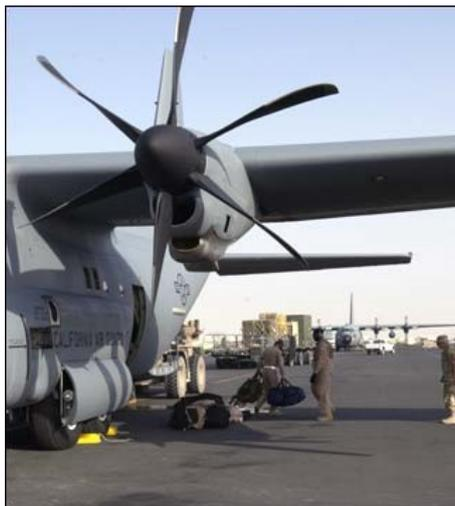
Figura 7 – Hélice de passo reversível
