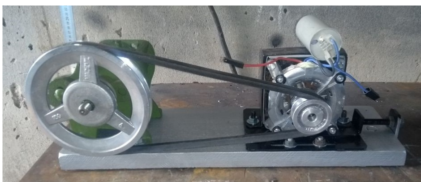
Figura 3 – Polias acopladas ao Descascador de Café e ao motor
