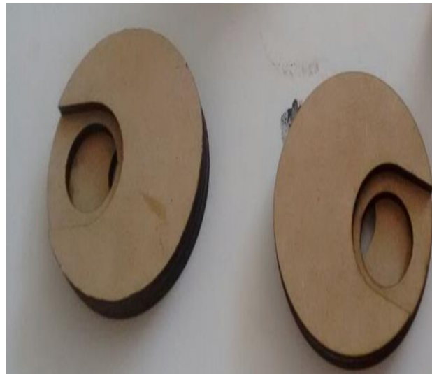
Figura 51: Partes do virabrequim de MDF
