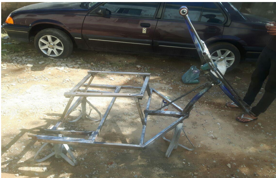
Figura 19: Lixamento da estrutura para fazer a pintura.
