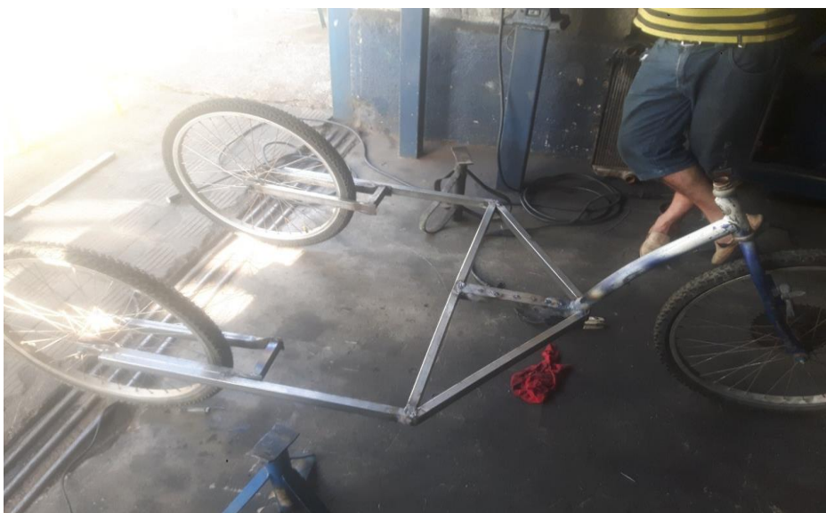
Figura 11: Fixação dos garfos traseiros.
