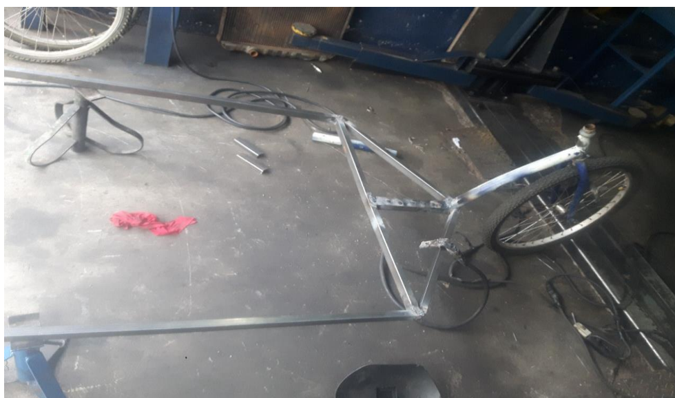
Figura 9: Junção do chassi com o quadro.
