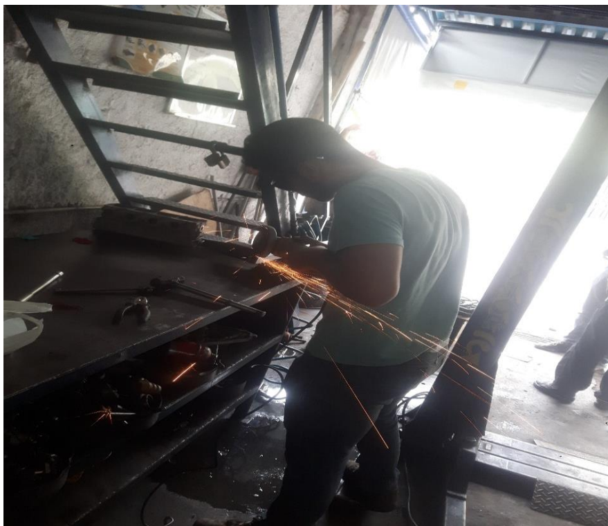
Figura 10: Corte dos perfis dos garfos traseiros.
