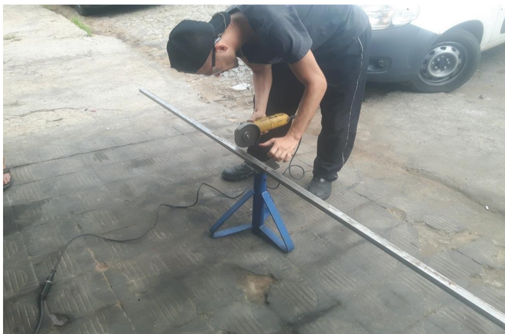
Figura 5: Corte das peças do chassi.
