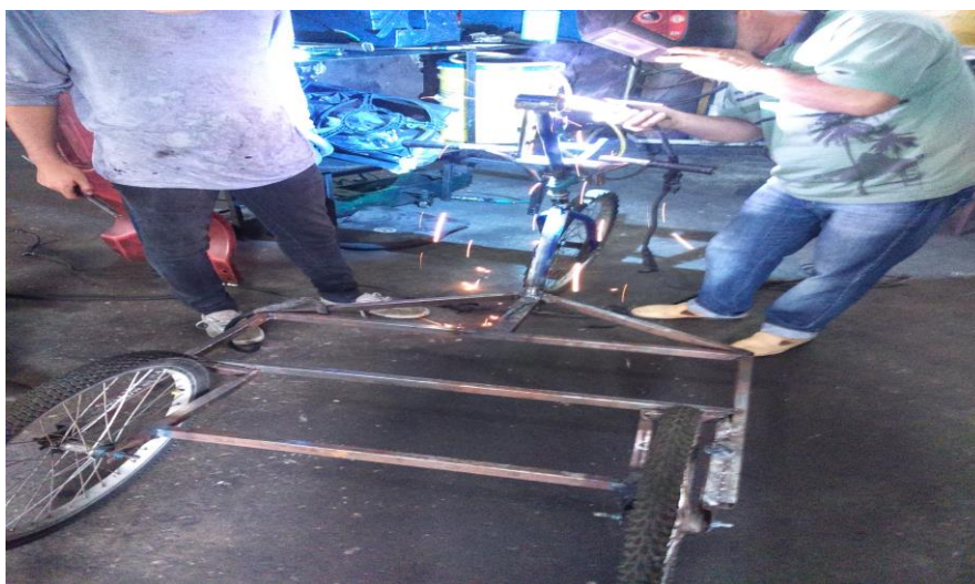
Figura 13: Fixação da caixa para pedal.
