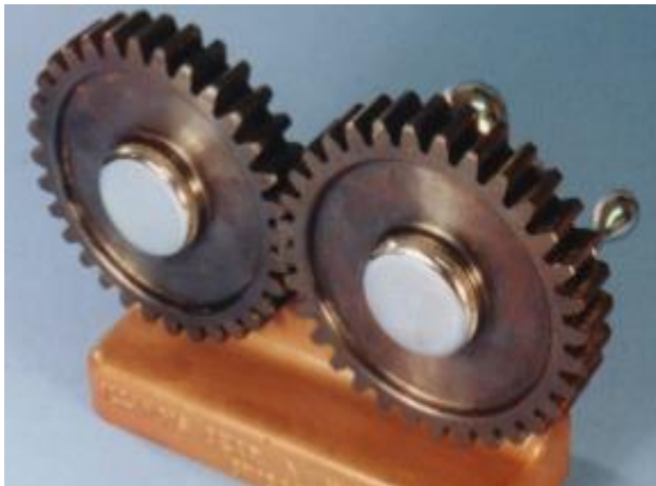
Figura 2: Engrenagens Cilíndricas de dentes retos.
