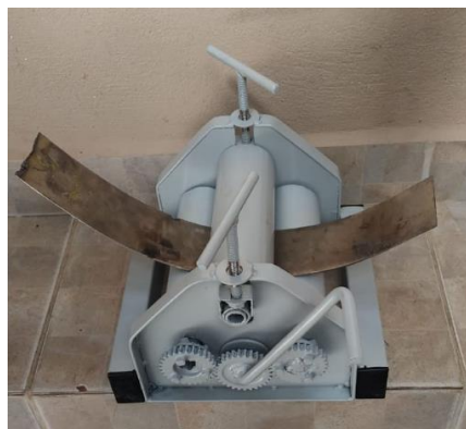
Figura 9- Calandra curvando chapa de 1,5mm
