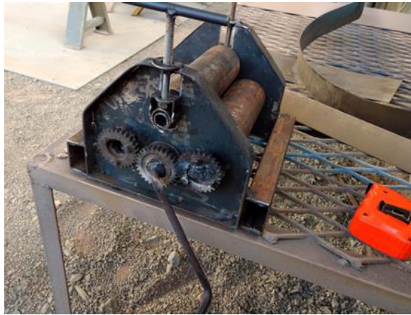
Figura 8- Calandra finalizada sem os acabamentos
