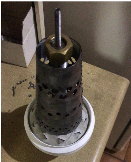
(a) Forro de combustão no eixo
