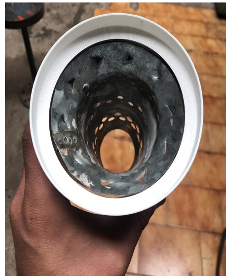
(b) Forro de combustão na lata externa
