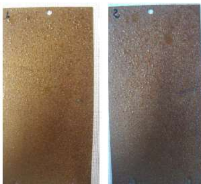
Figura 22 - Resultado do teste de Névoa Salina Neutra sendo a amostra da esquerda com fosfato de zinco da direita com nanocerâmico
