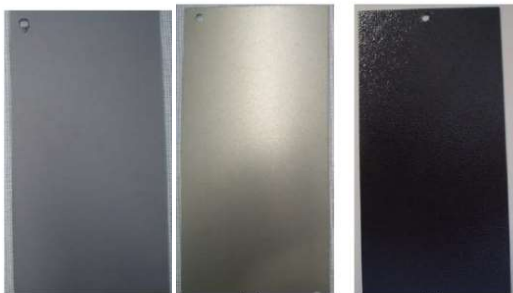
Figura 15 - Aspecto das chapas de aço carbono após processamento com fosfato de zinco e nanocerâmico
