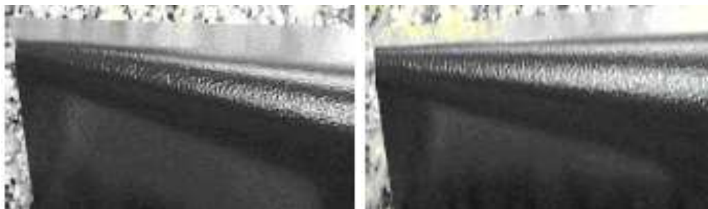
Figura 19 - Resultado do teste de flexibilidade sendo a amostra da esquerda com fosfato de zinco da direita com nanocerâmico
