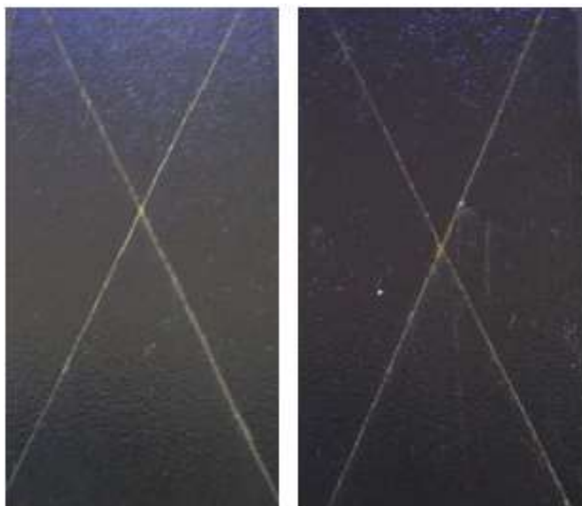
Figura 23 - 48 horas de teste de Névoa Salina Neutra sendo a amostra da esquerda com fosfato de zinco da direita com nanocerâmico.
