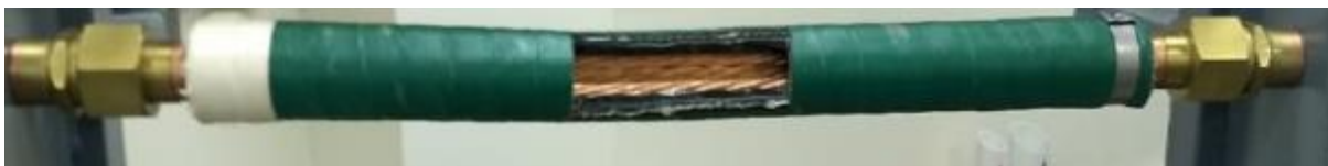
Figura 16 - Cabo elétrico refrigerado a água.
