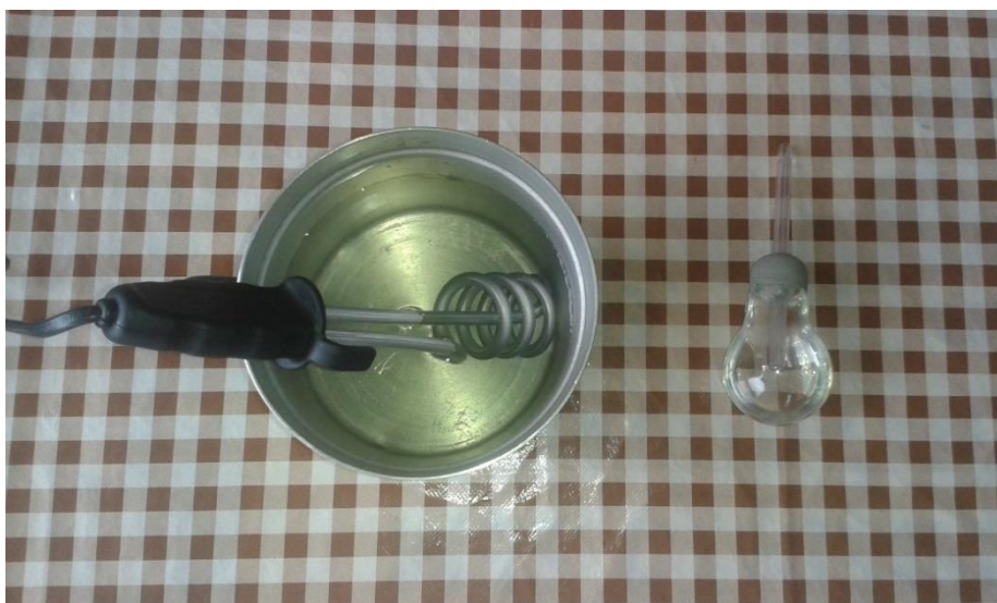
Aparato experimental da demonstração de dilatação dos líquidos. Acervo do autor.
