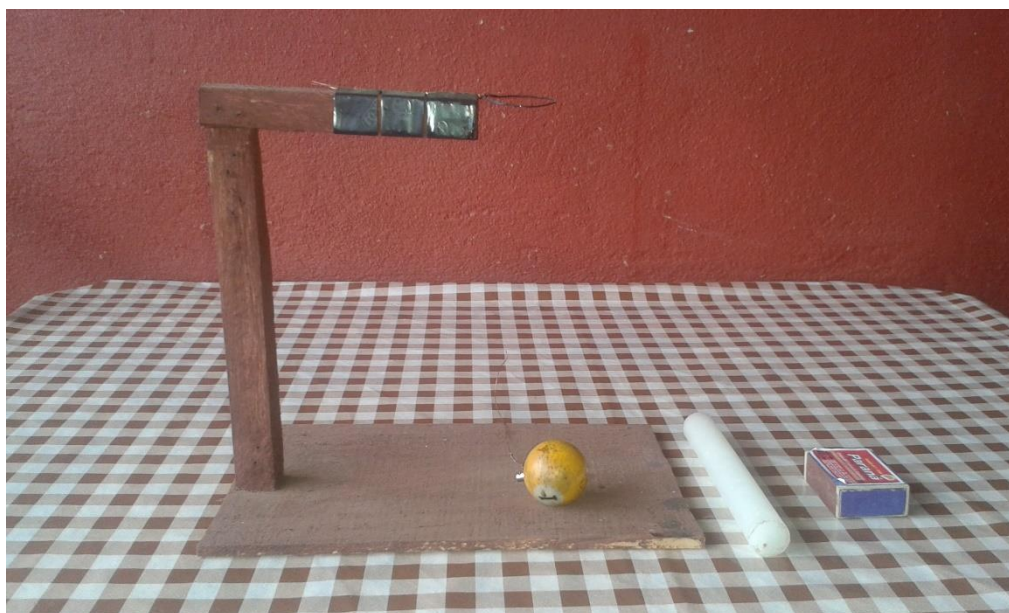
Aparato experimental da demonstração de dilatação dos sólidos. Acervo do autor.
