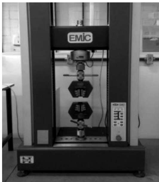
Figura 1. Equipamento utilizado no ensaio de tração dos corpos de prova de aço.
