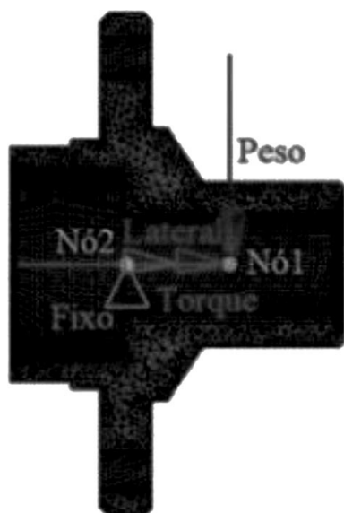
Figura 4. Condições de contorno para o cubo sujeito à curva.
