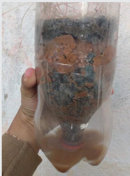
FIGURA 2: Modelo para ilustrar a filtragem da água pelo solo usado em regência.
