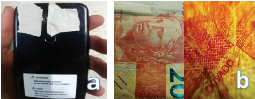
**Figura 7 .** (a) microscópio finalizado e (b) aumento de uma cédula de vinte reais.
