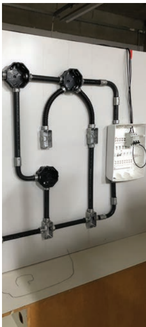
Bancada utilizada para montagem de circuitos de instalações elétricas residenciais e montagem de circuitos elétricos
