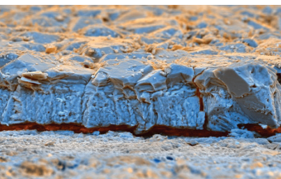
Imagem de Microscopia Eletrônica de uma fibra vegetal de açaí. Enviado por Cleidiane Cavalcante da Costa
