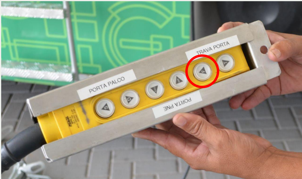
Figura 9: Botão F que deve ser pressionado para abertura dos pinos
