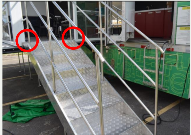
Figura 29a: Posicionamento dos pinos na porta palco
