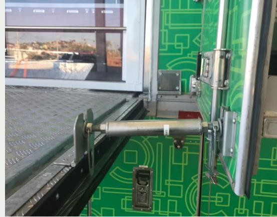
Figura 32: Extensor instalado na parte inferior da porta PNE
