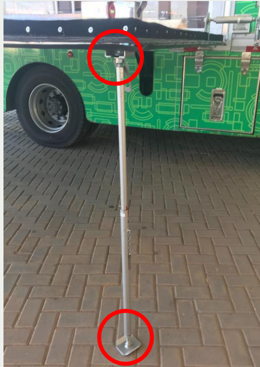
Figura 21: Ajuste de altura da haste, com rosqueamento superior e inferior
