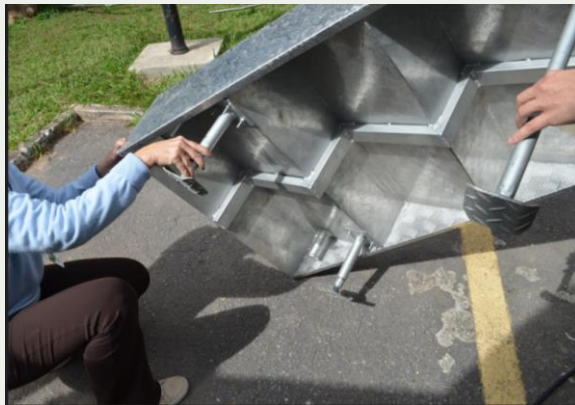
Figura 30: Encaixe dos suportes na escada
