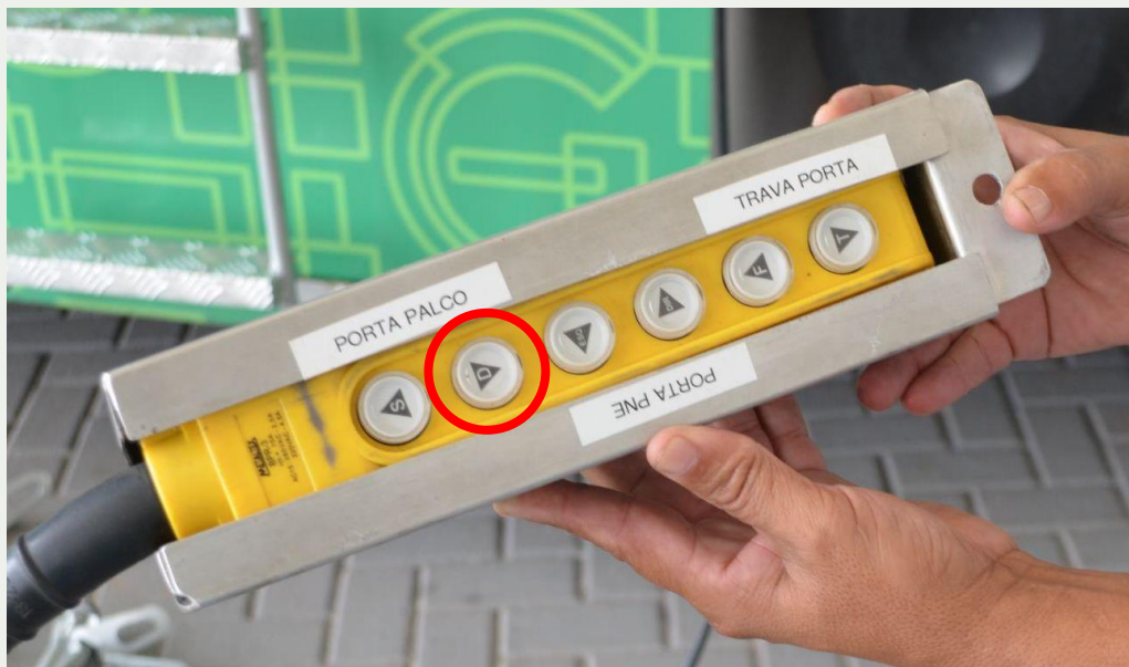
Figura 16: Botão “D” para descer a porta palco
