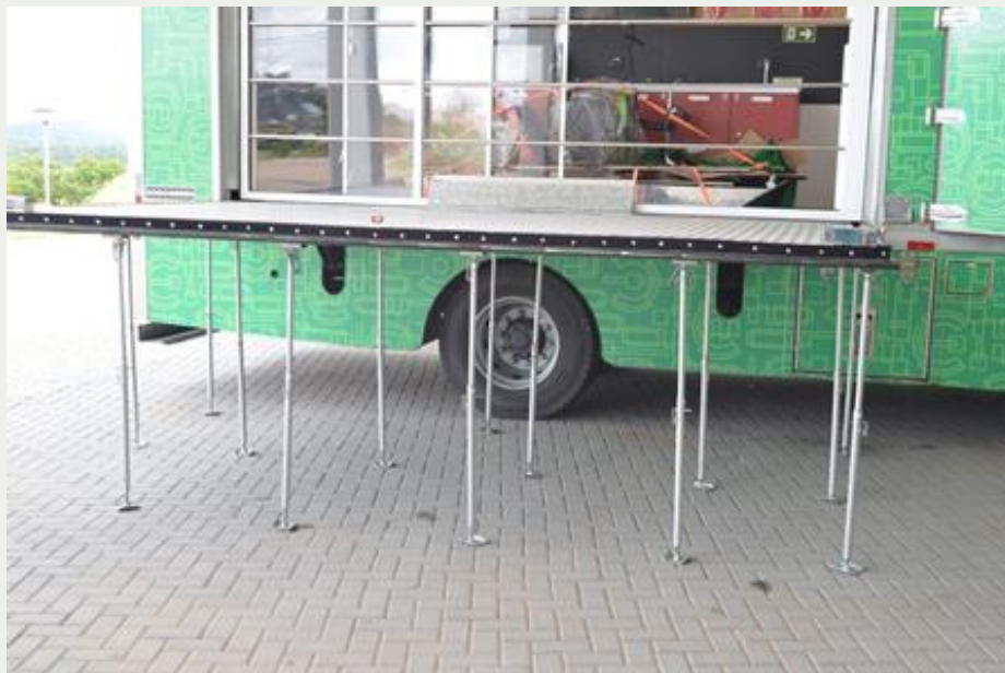
Figura 22: Instalação das 15 hastes de apoio da porta palco
