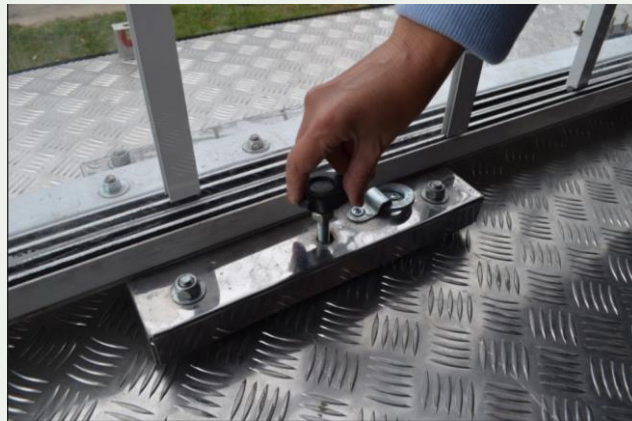
Figura 27: Travamento da cabine
