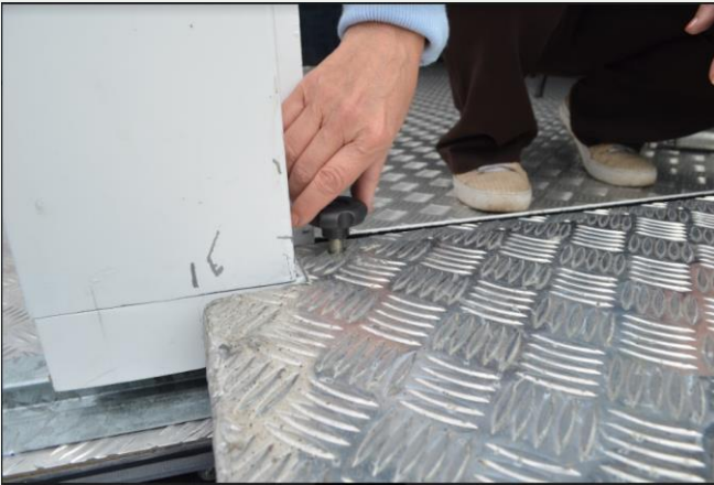
Figura 29: Posicionamento dos pinos da escada na porta palco
