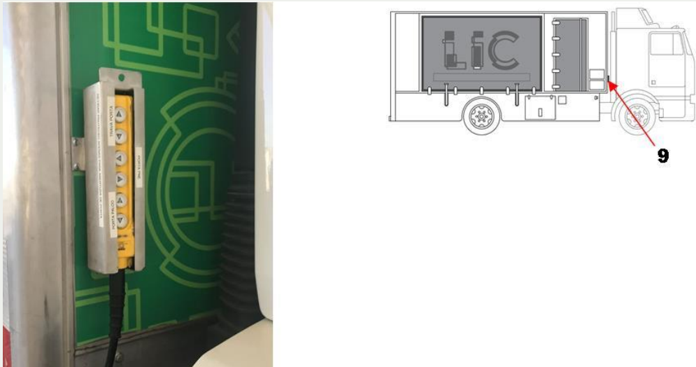
Figura 15: Localização do controle manual de acionamento
