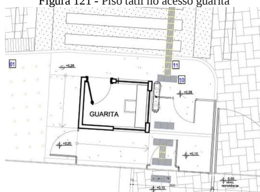
Figura 121 - Piso tátil no acesso guarita
