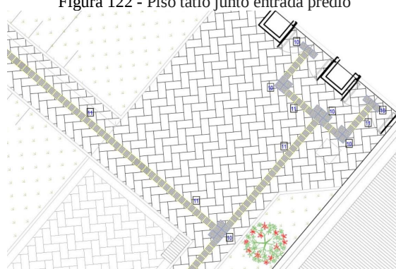
Figura 122 - Piso tátil junto entrada prédio
