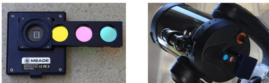
**Figura 1:** Câmera CCD com filtros LRGB usada na obtenção de astrofotografias e sua devida montagem ao telescópio.
