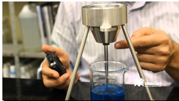
Figura 1. Imagem do Viscosímetro Copo Ford. Fonte: Disponível em https://i.ytimg.com/vi/sYjghwPXeiM/maxresdefault.jpg .
