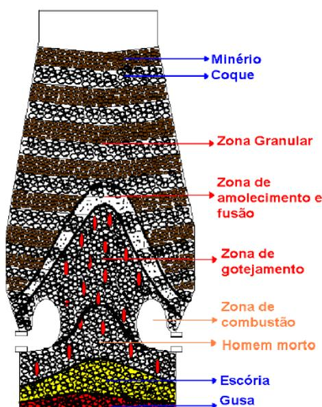
Figura 1: Esquema da região interna do Alto-Forno, mostrando as várias zonas (CASTRO, 2002).
