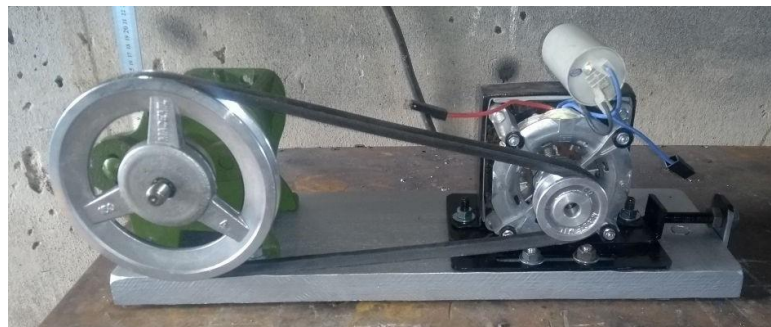
Figura 4 – Sistema de polias acoplado ao motor elétrico
