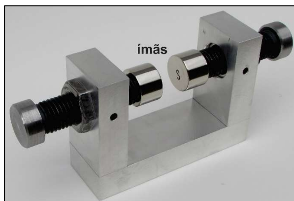
Figura 2 – Suporte construído para a produção de um campo magnético variável entre os ímãs.
