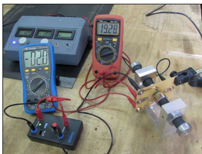
Figura 4 – Realização da medição da tensão Hall na amostra de semiconductor.
