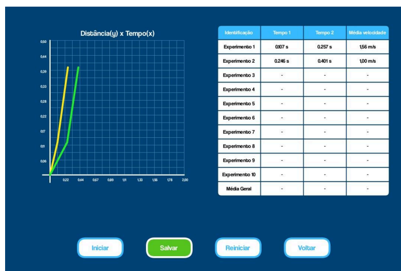
Figura 2 - Tela do experimento de velocidade média da interface desenvolvida no Processing . Fonte: Elaboração própria.
